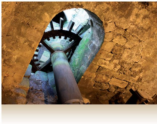
La ferrería tiene dos ruedas hidráulicas que se ubican bajo la antepara: una que mueve los fuelles y otra activa el mazo. Están formadas por una serie de palas que al chocar el agua con ellas provoca el movimiento. Este es transmitido a través de un eje al mazo y a los fuelles. Las ruedas girarán a mayor o menor velocidad en función de la cantidad de agua que se desvíe del río, pudiendo controlar el ferrón desde el interior el paso del agua.
